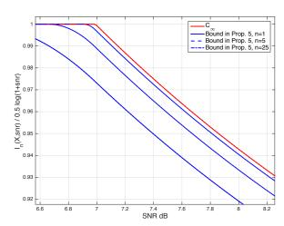
Fig. 4: Bounds on  $C_n(\mathsf{snr},\mathsf{snr}_0,\beta)$  vs.  $\mathsf{snrdB}$ , for  $\beta=0.1$  and  $\mathsf{snr}_0=5=6.9897$  dB.
